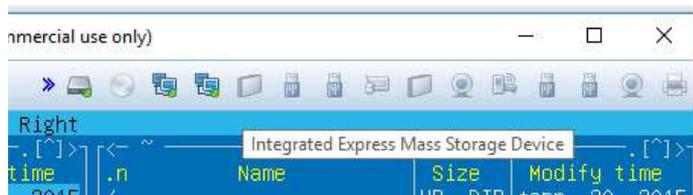
Функция очень полезна, потому как позволяет подключить картридер непосредственно в виртуальную машину и напрямую оперировать с картами памяти.
