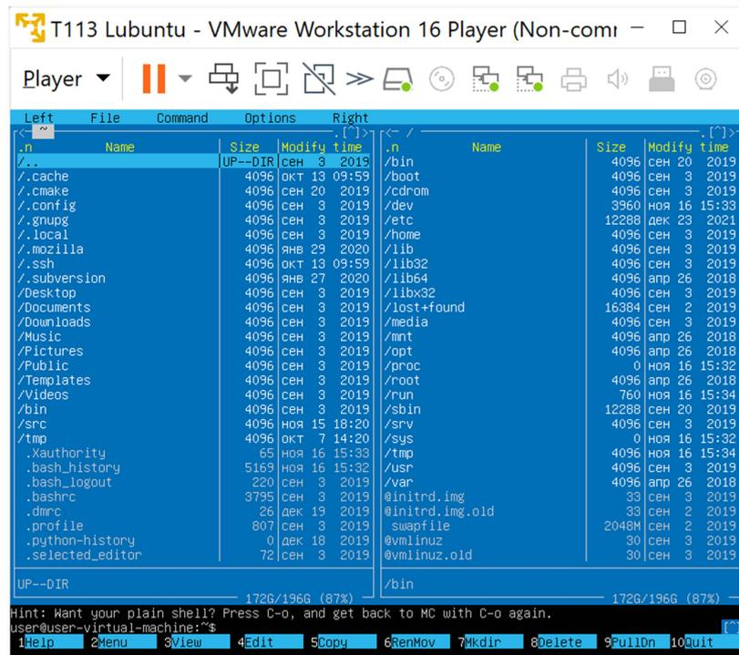
Через раздел **Player>Removable devices** можно подключать-отключать к виртуальной машине различные системные устройства, например, USB устройства, картридеры и т.п. Эта же функция дублируется через графическую панель:
