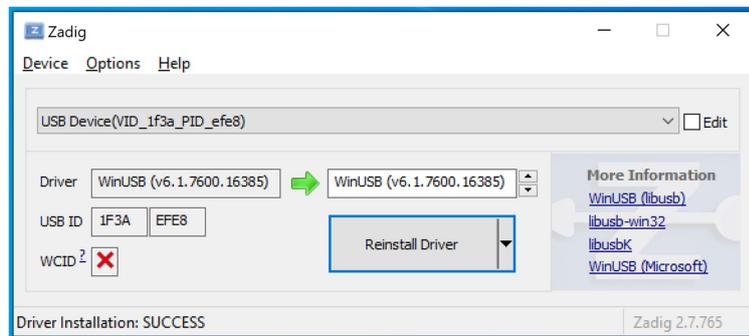
В результате, при включении модуля в режиме загрузки по USB в диспетчере устройств Windows должно появляться устройство в разделе «Устройства USB»:
